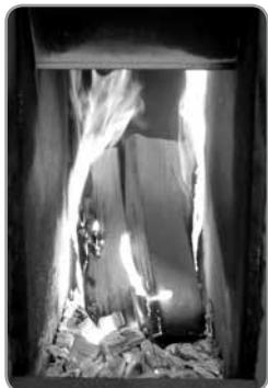
更に長い放熱を希望される場合は、熾き燃焼が充分にある時に2本の薪を再投入して下さい。火を大きくしたい時や追加の薪を投入する時は、火かき棒で熾き火を均一に広げて下さい。
