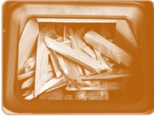
燃焼室バックパネルにやや傾けるようにして、薪を立てて置いてください。薪の重さで火床が下がり燃焼用空気が供給されます。ストーブ燃焼室には長さ33cmに切られた薪をご使用ください。異なる樹種の薪を投入しても、これらの薪は同時に燃やされます。着火材に火を点けドアをロックしてください。木は上から下へと燃えていきます。
